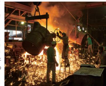
溶かした鉄を流し込む「湯入れ」
